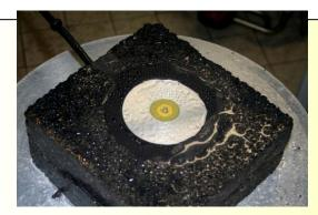
Der Sensor erfüllt damit die Genauigkeitsanforderungen des Entwurfs der DIN EN 15518-3 für den Parameter "Gefriertemperatur".
